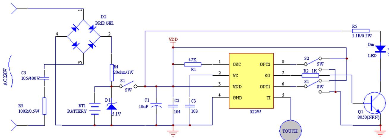
图 2、使用充电电池供电时的应用电路
