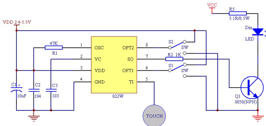
图 3、使用开关电源供电时的应用电路
