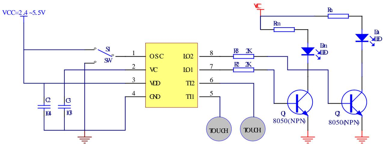
图 1、直流供电情况下的应用电路
